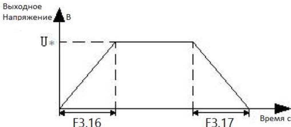
Рисунок F3-7 Режим управления напряжением 2
