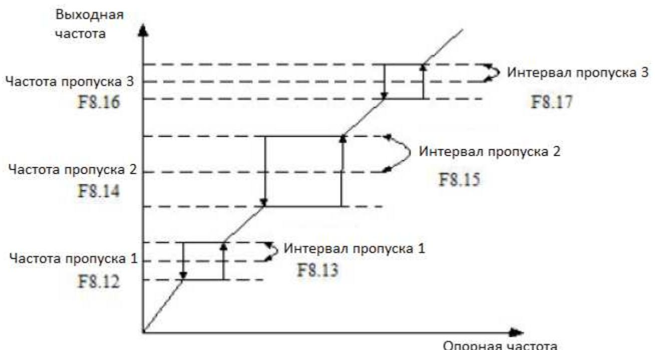
Рисунок F8-2 Пропуск частоты
