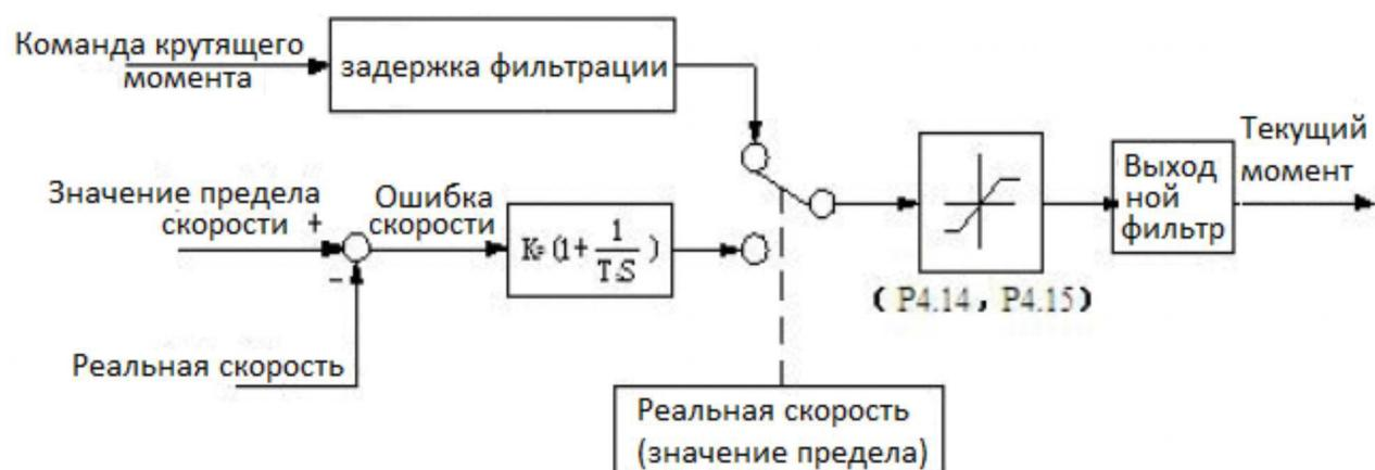
Рисунок F2-2 Упрощенная схема управления крутящим моментом
