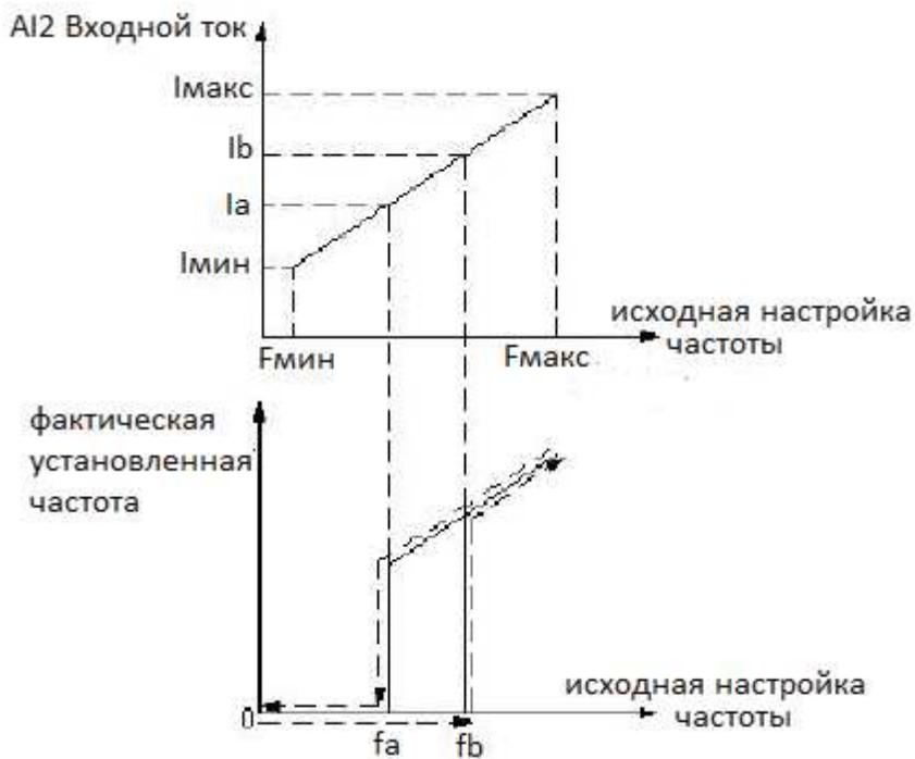
Fb: значение порога срабатывания при нулевой частоте
