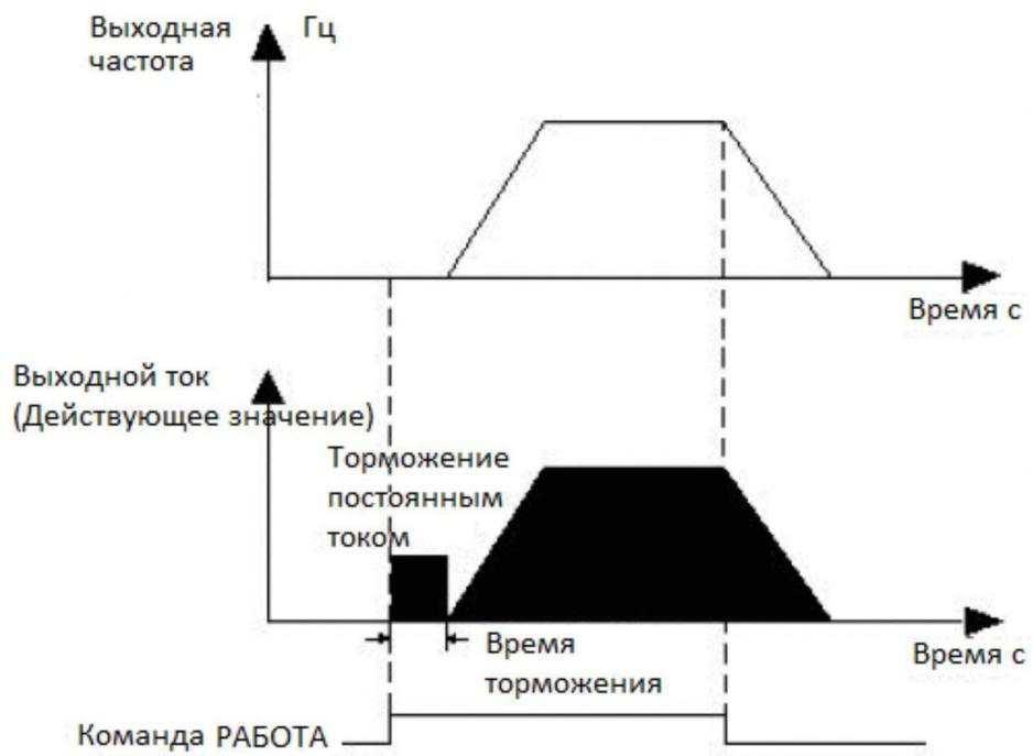
Рисунок F6-2 Торможение постоянным током при запуске
