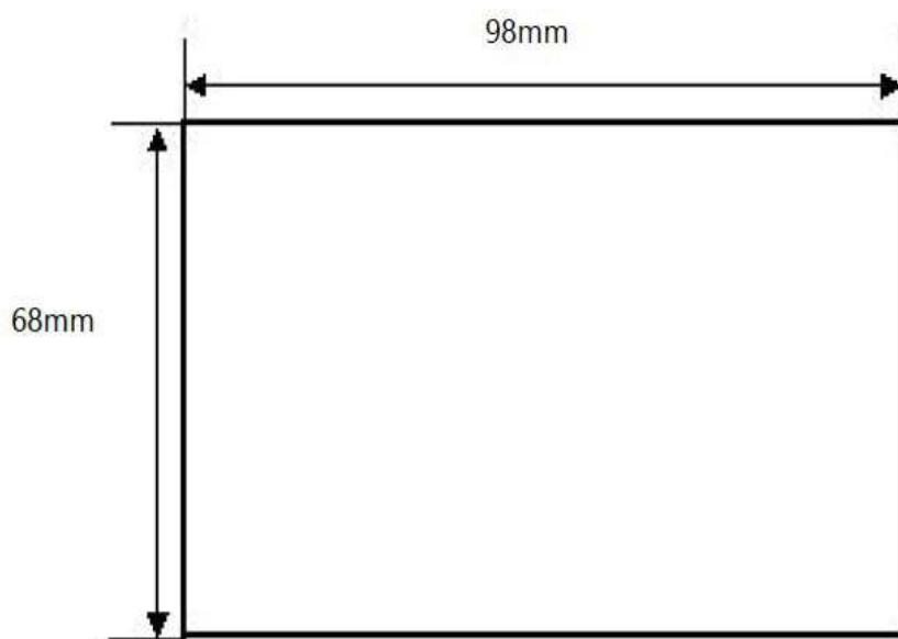
Установочные размеры внешней клавиатуры (размеры установочного отверстия)
