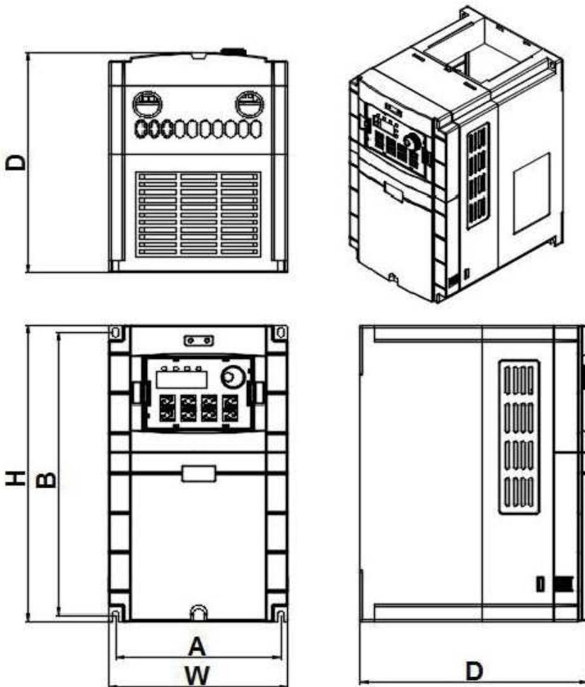
Рисунок 1 Преобразователь частоты 0,75 кВт ~ 315 кВт внешние размеры
