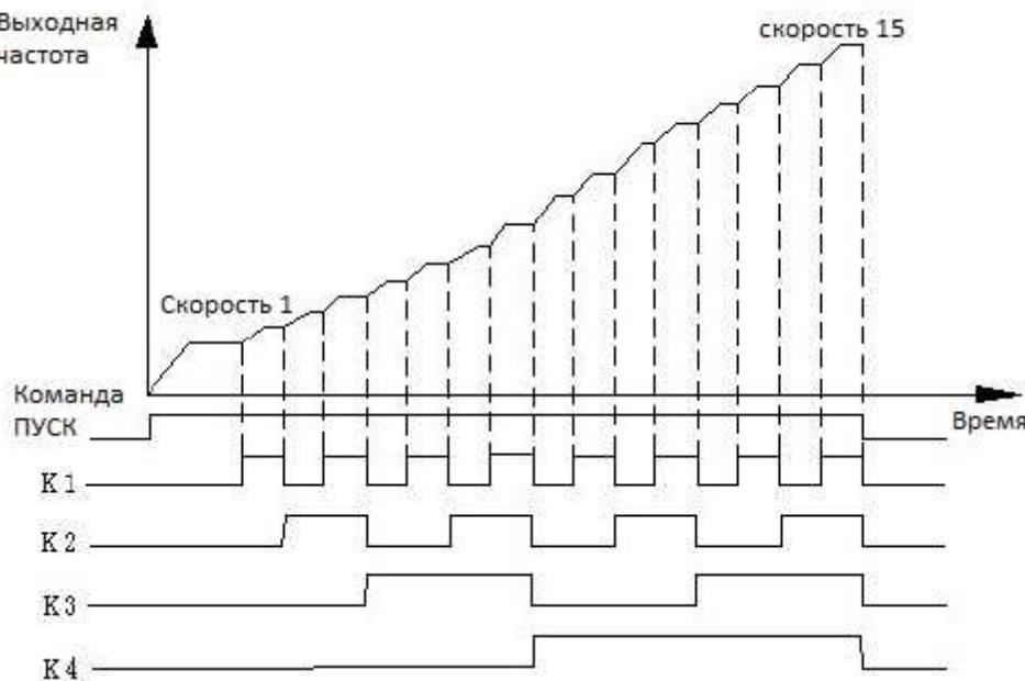
Рисунок F 4-1 Работа на многоступенчатой скорости
