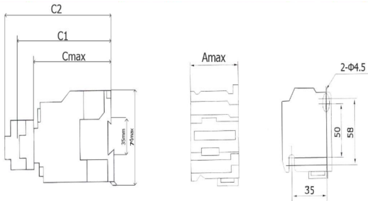
Рисунок 1 – Габаритные и присоединительные размеры пускателей 9-12А
